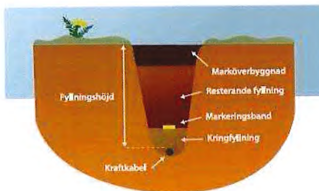
Figur 3. Exempel på principskiss för kabelschakt med arbetsområde, bildkälla EBR KJ41:21 Kabelförläggning max 145 kV
